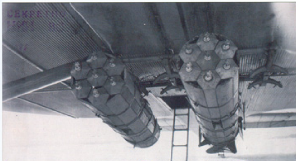
Агитационные ротативно-рассеивающие авиабомбы конструкции полковника Львова, выполненные в калибре 1000 кг, снаряжали более мелкими анероидными АГИТАБ его же конструкции. На снимке 1936 г. - контейнеры со снятыми передними обтекателями под центропланом бомбардировщика ТБ-3.
