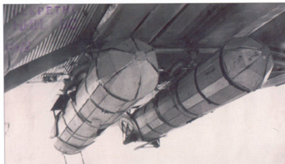
Агитационные РРАБ конструкции «спецгруппы ВВА имени профессора Н.Е.Жуковского» после удаления транспортировочных чех на дистанционных трубках суббоеприпасов закрывали характерными только для АГИТАБ передними обтекателями.
