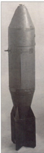
Агитационная авиабомба варианта №4 с корпусом из фанеры конструкции НИИСИ разработки инженера Кутусова.
