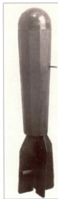
Агитационная авиабомба варианта №2 с корпусом из фанеры конструкции НИСИ разработки инженера Глаголева.
