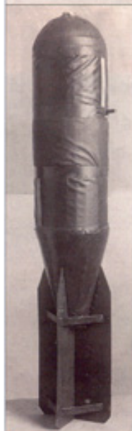
Агитационная авиабомба варианта №3 «без оболочки» (с клеенчатым корпусом) конструкции НИИСИ разработки инженера Красильщикова.
